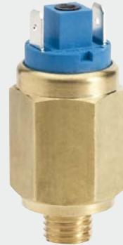
**Il Presso-termostato** è costituito da un **Pressostato** a membrana a taratura regolabile, con contatto elettrico N.A. oppure N.C., che integra un **Termostato** bimetalllico a taratura fissa con il contatto, N.A. oppure N.C., collegato a quello del pressostato.
