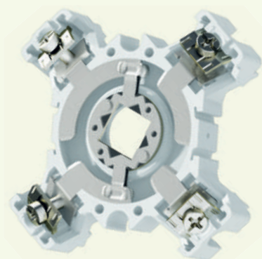
Double bridge Rotor contact Knife type Fixed contacts with self-cleaning effect. Contatto mobile a doppio ponte contatti fissi a coltello con effetto strisciante autopulente.
